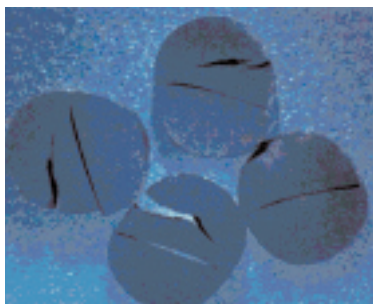
Bild 2. Beschädigungstiefe verursacht durch Dekompression.
